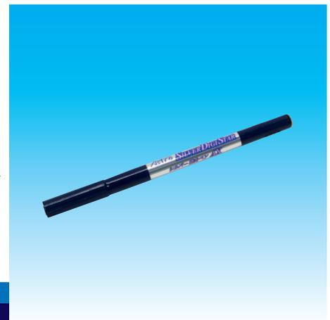
シルバーマスターの版面上で、消去したい箇所へ塗るだけのカバーコートタイプの消去ペンです。従来のシルバーマスター用消去ペンは、画像部を溶解させることで消去を行いましたが、『シルバー消去ペン AX』は、画像部を親水化することで不感脂化被膜を形成し、インキを付着させないカバーコート方式を採用しております。アルミ CTP シルバーマスターの消去したい箇所に 3 往復以上塗布すれば消去完了となり、画像部が見えていてもインキが乗ることはありません。
